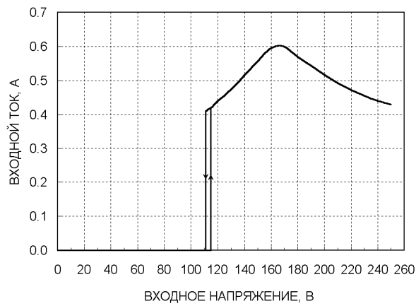
Рис. 1. Зависимость входного тока от входного напряжения для модулей МПС60 при I_O = I_{O,max} и T_C=25^\circ C
