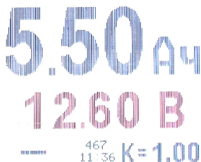
рис. 4. Дисплей прибора в режиме записи результата по команде.
