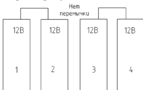
Рисунок 2.1 – Рекомендуемая конфигурация сборки АБ перед подключением
