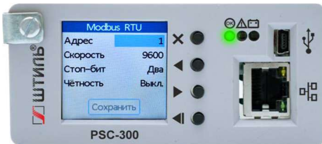
Рисунок А13 - Окно "Modbus RTU "
